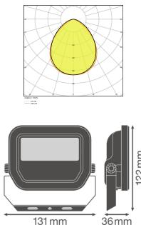
**Scheda tecnica Ledvance Proiettore LED GEN 3 Nero 10W 1200lm 100D - 865 Luce del Giorno | IP65 - Simmetrico**
