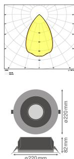
**Scheda tecnica Ledvance Downlight LED Performance DN195 21W 2520lm 65D - 840 Bianco Freddo | 220mm - IP54 - Dali Dimmerabile**
