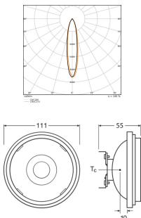
**Scheda tecnica Ledvance LED spot G53 AR111 11.7W 450lm 40D - 930 Luce Calda | Miglior resa cromatica - Dimmerabile - Sostitua 50W**
