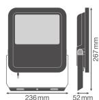
**Scheda tecnica Ledvance Proiettore LED 100 Aluminium Bianca 69W 10000lm 100D - 840 Bianco Freddo | IP66 - Simmetrico**
